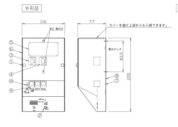
※2 止め穴はスイッチボックス取付ピッチに適合しています。
