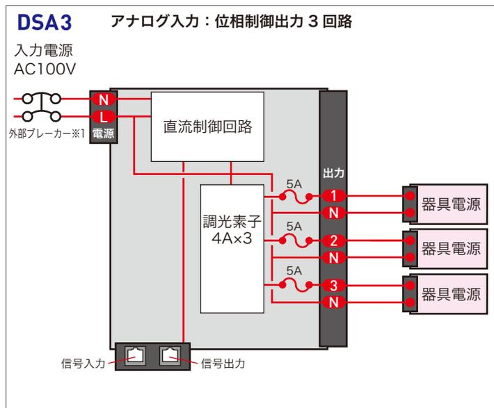
※1 必ず 20A 以下の保護ブレーカを使用してください。
